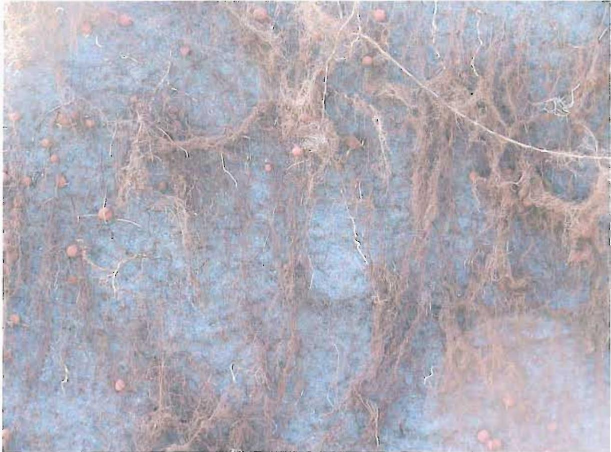
Abb. 3: Gut durchwurzeltes Schutz- bzw. Trennvlies (200 g/m<sup>2</sup>) der Kontrolle
