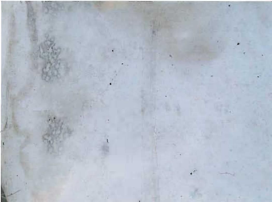
Abb. 2: Abdichtungsunterseite (außen) ohne Einwurzelungen
